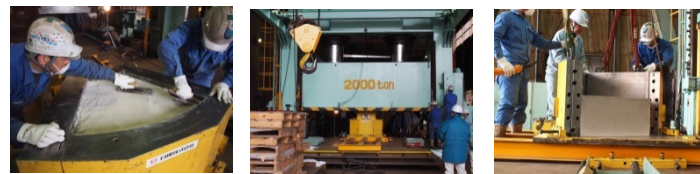
①材料投入 ②圧縮成形 ③型枠解体
