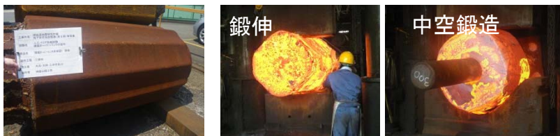
①炭素鋼素材 ②鍛造工程
