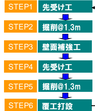
崩落性地山に対する地山安定化対策 (ボルトによる補強とシリカレジンを注入により安定性を向上)
