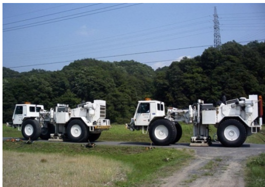
反射法弾性波探査
