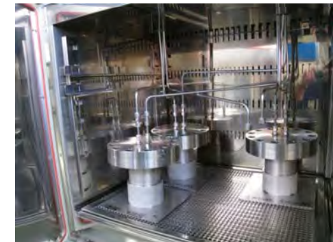
高温・高圧下での腐食試験状況の例
