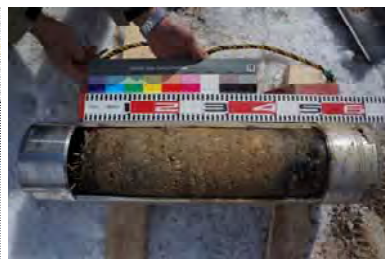
採取された土壌コアの例 U-8容器
