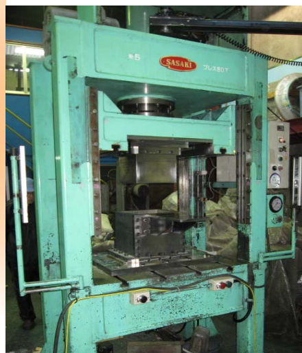
↑埋め戻し材ブロック 製作装置
