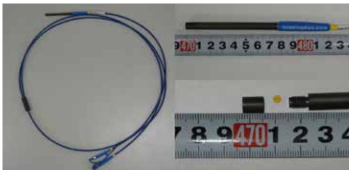
緩衝材中の間隙水のpHをモニタリングするための技術例 (光ファイバー技術を利用した測定手法)
