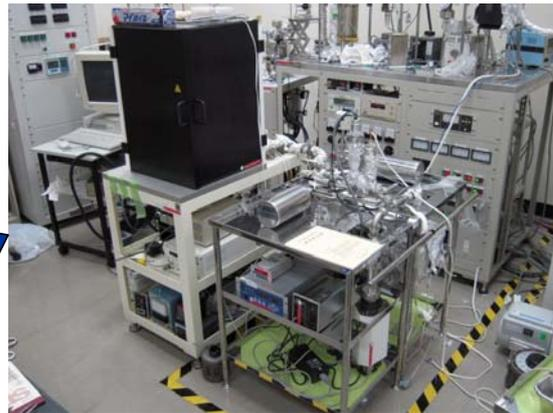
希ガス用質量分析装置およびレーザー照射装置(手前)
