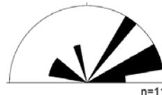
水素ガス放出量の分布に不均質性が認められ、水素ガスの放出は、跡津川断層の方向(ENE走向)に対して高角な走向を持つ破碎帯で、高濃度の水素ガスが放出される傾向がある。
