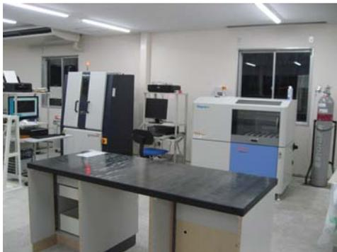
蛍光X線分析装置(XRF)・X線回折装置(XRD)
