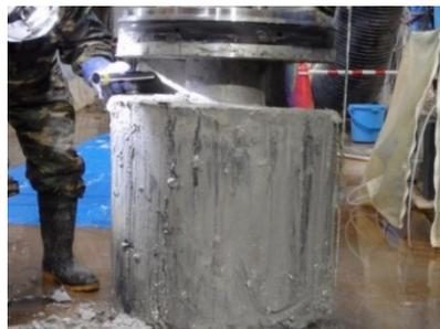
人工バリア性能確認試験場所を解体し、実際の緩衝材の飽和度測定など、これまでの解析結果を検証するための調査を行う。
