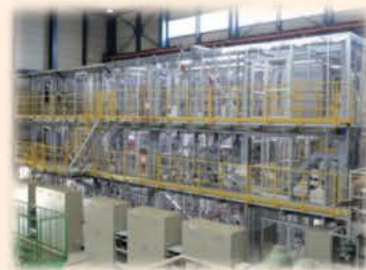
連続水素製造試験装置
