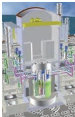
ナトリウム冷却タンク型高速炉
