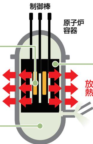
電源や冷却材が喪失しても、自然に出力が低下し、冷え、炉心から放射性物質は放出されません。
