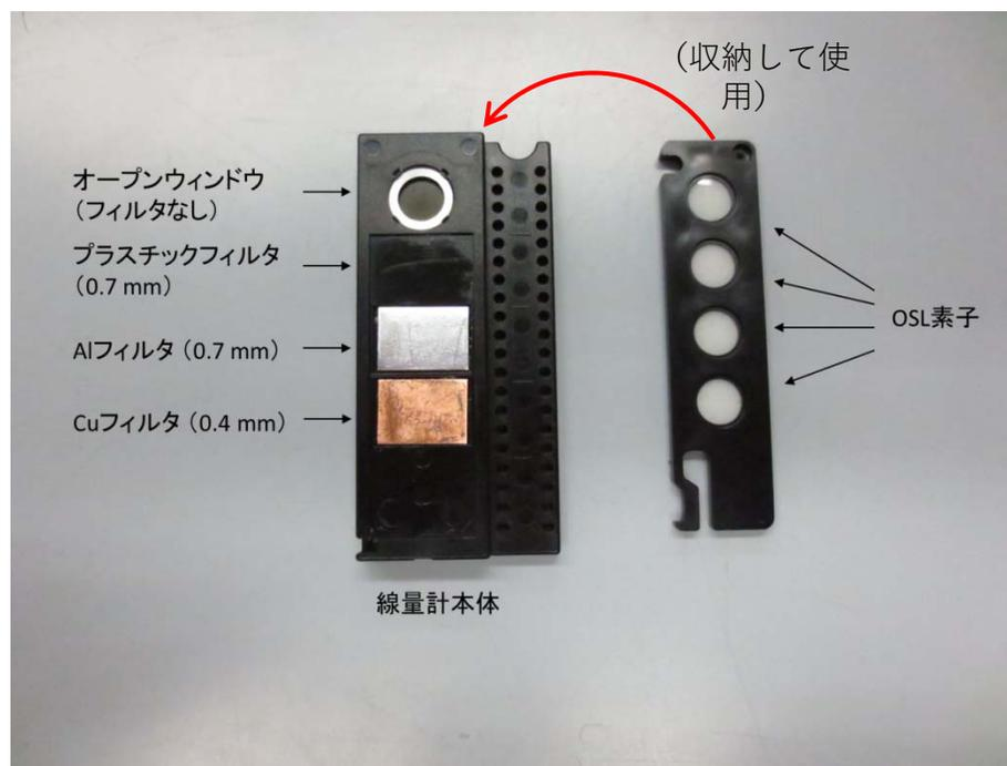
写真1 線量計本体の構造
