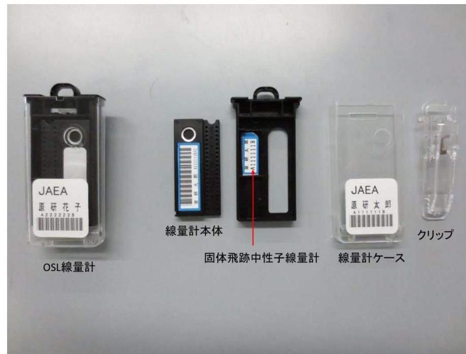
写真2 OSL線量計の構造
