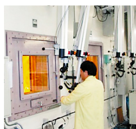
使用済み燃料を遠隔操作で取り扱うアクチノイド分離化学研究設備 (BECKY)
