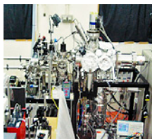
試料中の原子個々の種類と配置がわかるフェムト秒レーザーにより駆動する、照射材用3次元アトムプローブ
