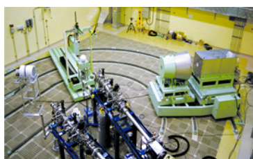
中性子測定器のエネルギー 特性等を試験するための単 色中性子照射設備
