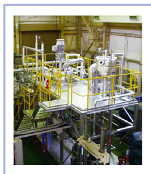
加速器駆動核変換システムで用いる冷却材（鉛）物質の伝熱流動を試験する装置
