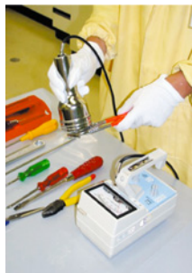
作業工具等の 表面汚染検査
