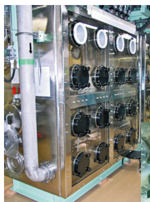
固体燃料と溶液燃料を組み合わせた溶解槽の模擬
