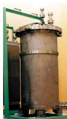
固体燃料と溶液燃料を組み合わせた溶解槽の模擬
