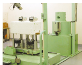
γ線を照射して サーベイメータを校正
