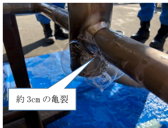
写真 2.8.4-2 気化管の漏えい検査状況
