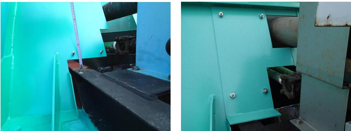
図 2.6.10 ベース架台とケーシングの開口部
