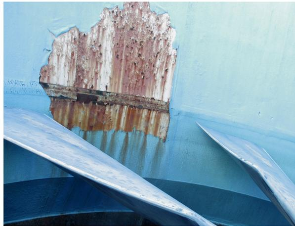
図 2.6.8 内部塗膜の剥離
