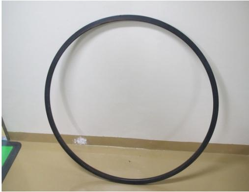
図 2.1.6 隔離弁シートパッキン
