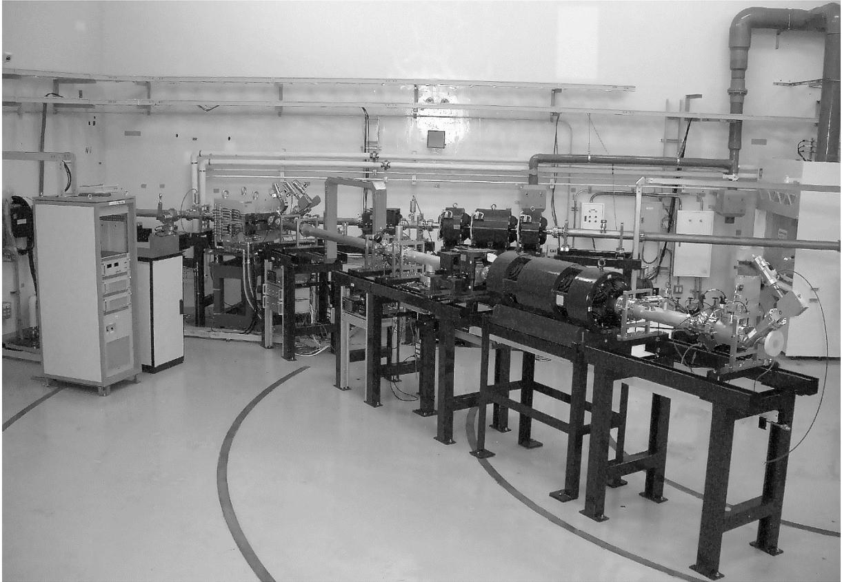
図 2.6.18 新設した第 2 照射室のビームライン
