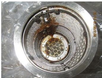
図2.1.2 イオン交換樹脂の捕集状況
