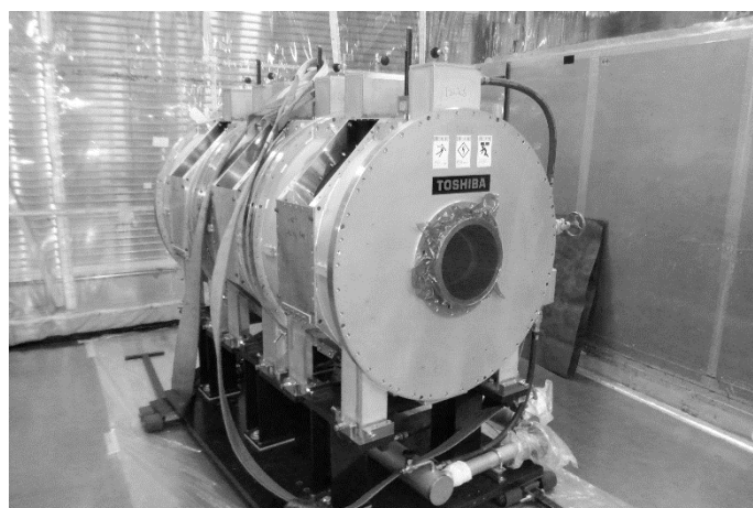
図 3.4.2-2 J-PARC の大型異型廃棄物（加速器空洞機器）
