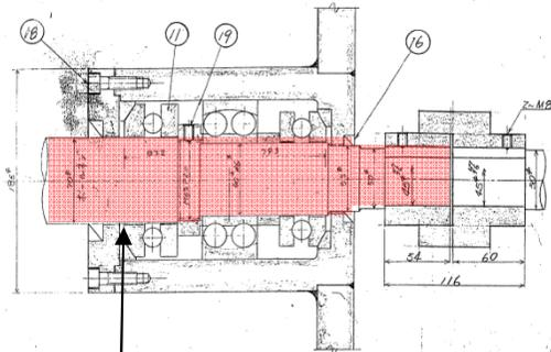
カップリング部よりセル内駆動軸が抜け、開閉動作不能。
