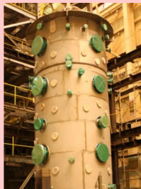
大型格納容器実験装置 (CIGMA)
