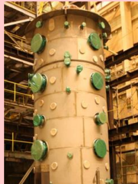
大型格納容器実験装置 (CIGMA)
