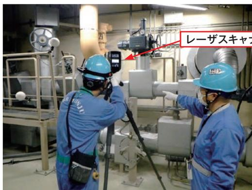
3次元レーザースキャナーによる点群データ測定の作業風景
