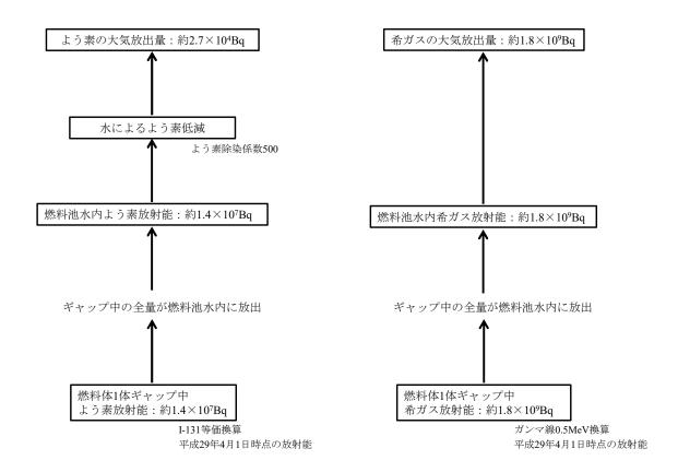
第10-1 図 燃料取扱事故時の希ガス及びよう素の大気放出過程
