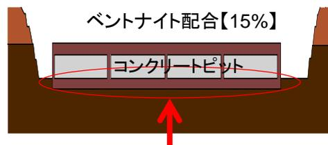
上部・側部へのベントナイト混合土の設置により合理的な埋設施設とすることができることを確認
