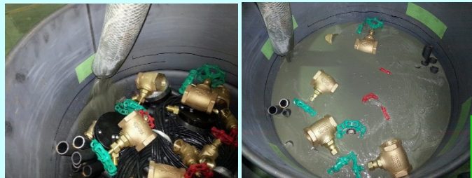
模擬廃棄物を密に収納した容器内へモルタルを充填
