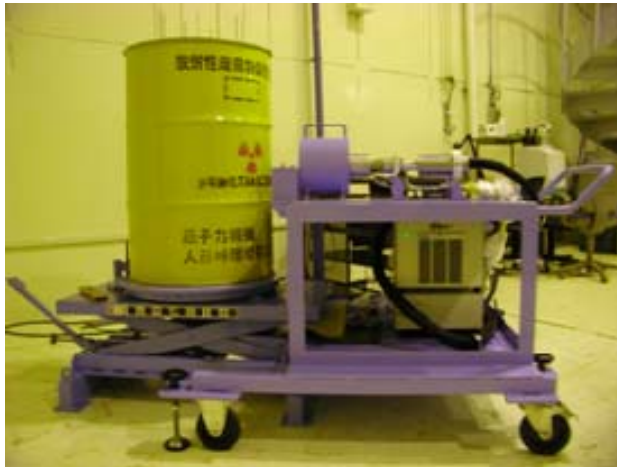
Ge検出器を用いた測定状況
