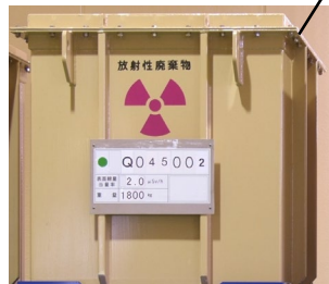
角型容器に金属類を収納し砂等を充填
