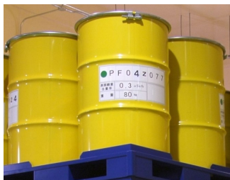
ドラム缶に廃棄物を収納し砂等を充填
