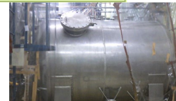
タンク等の内部を固型化し た廃棄体
