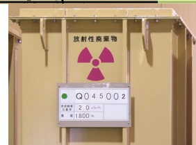
角型容器に廃棄物を固 型化した廃棄体
