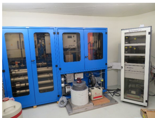
VIC 屋上に設置されている希ガス観測装置
