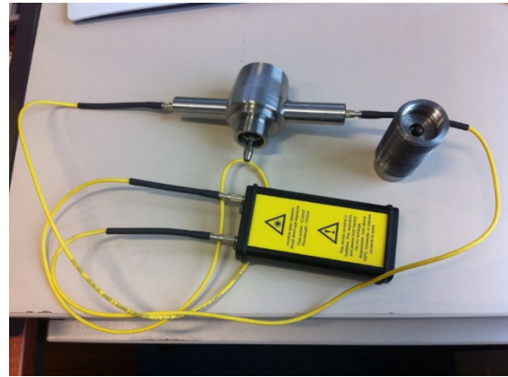
図 2 乾式貯蔵キャスクに適用される 2重の C/S 装置 UOSB (Ultrasonic Optical Sealing Bolt) 光学封印と超音波封印が用いられている。
