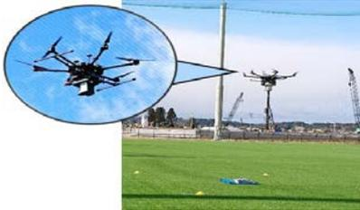
ドローンを用いた放射性物質探知試験
