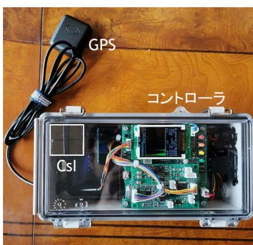
図 1 GPS 機能付き可搬型ガンマ線測定装置
