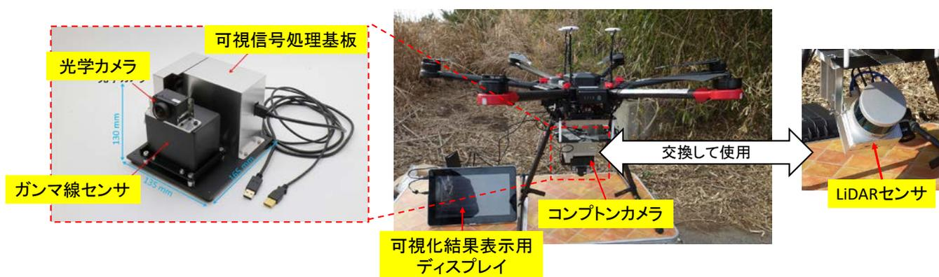
図3 小型ガンマ線カメラ(コンプトンカメラ)を搭載したドローン
