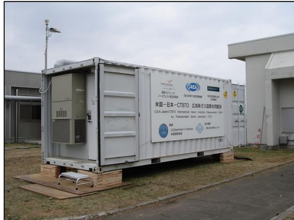
図1 移動型希ガス観測装置(TXL)
