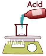
灰に酸を加え分解し溶液状にする
