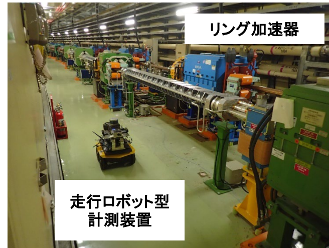
走行ロボットを用いた測定試験の様子
