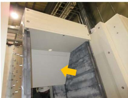
(a-2) PGA測定用に取り付けられた複合体遮蔽体 (Mark-III内部、矢印部)
