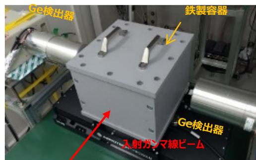
遮蔽容器を模擬した鉄製の箱に、模擬試料(Pb-208)を入れ、LCSガンマ線を照射して、NRF散乱ガンマ線を容器横のGe検出器で測定
