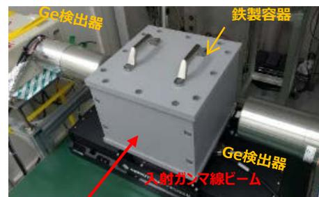
コンテナを模擬した鉄製容器の中に、模擬試料（Pb-208）を入れLCSガンマ線を照射して、NRF散乱ガンマ線を容器横のGe検出器で測定する模擬核検知実証実験を実施した。
