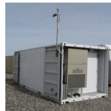
移動型希ガス観測装置 (TXL : Transportable Xenon Laboratory)
