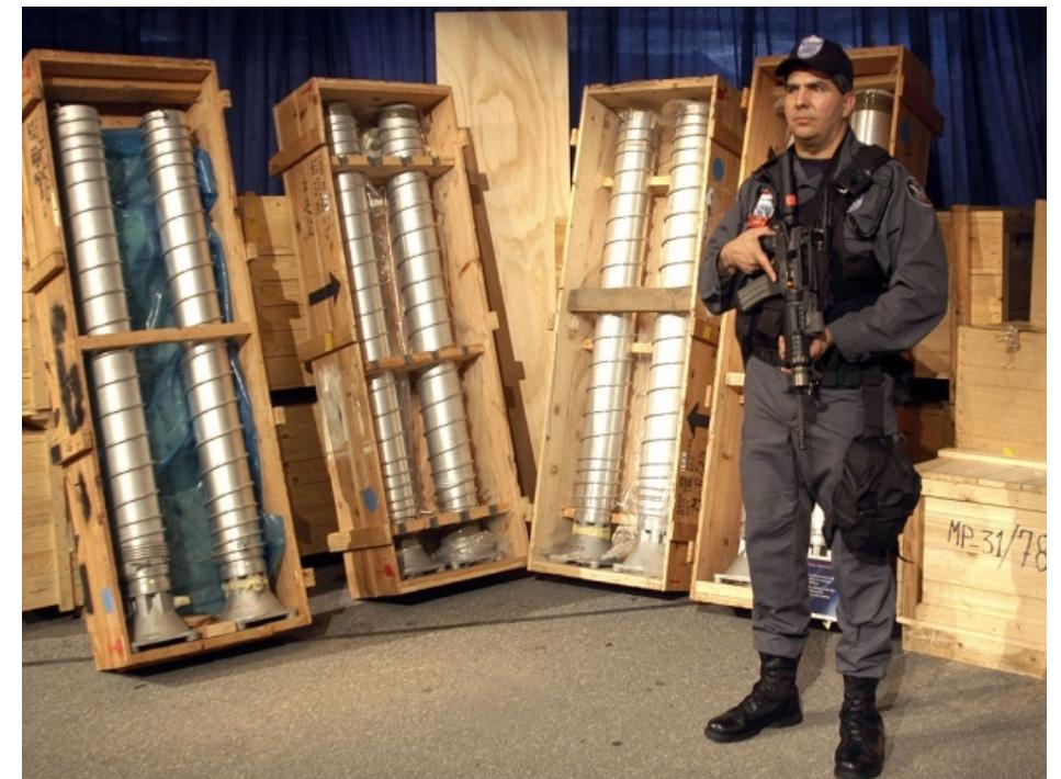
オークリッジ国立研究所に保管されているリビアから搬出されたP1型遠心分離機
