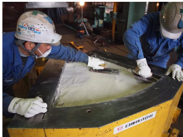
緩衝材ブロックの製作と試験孔への定置
