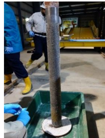
模擬オーバーパックの取り出し・腐食生成物の採取
