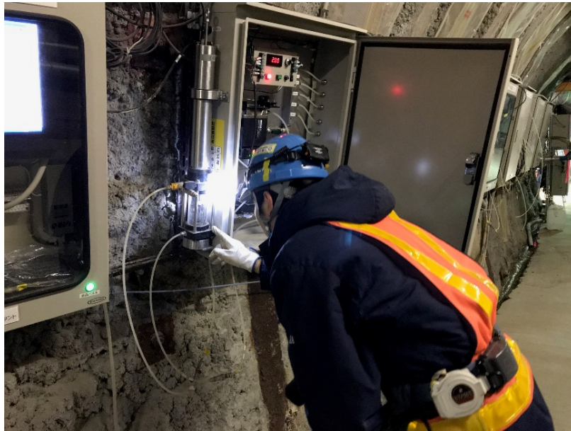
地下水の水圧・水質 連続モニタリングの様子 (深度350m調査坑道)
