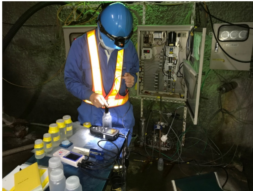
地下水の水質調査の様子 (深度140m調査坑道)
