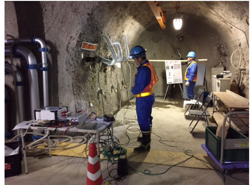
弾性波トモグラフィ調査の様子 (深度140m調査坑道)
