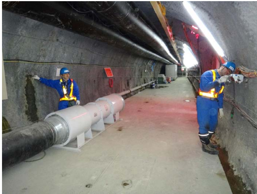
内空変位測定の様子 (250m調査坑道)
