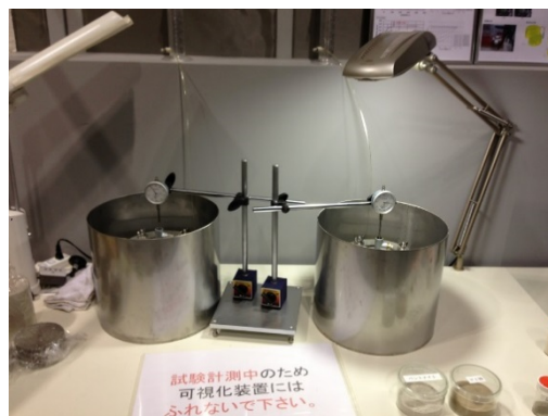
(b) 緩衝材可視化試験装置の設置状況
