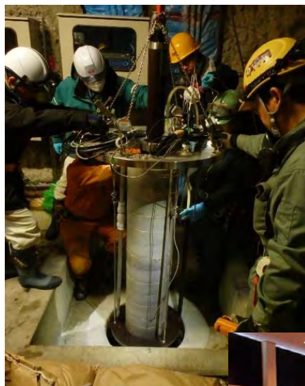
原環センター原子力機構 共同研究 掘削した試験孔に 試験体を設置している様子 (平成27年1月、 於 350m調査坑道)
