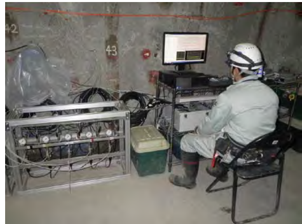
写真 40 単一割れ目を対象とした 原位置トレーサー試験状況 (モニター確認)
