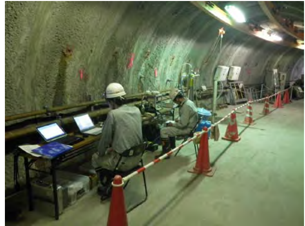
写真 34 健岩部を対象とした単孔水理試験状況（モニター確認）
