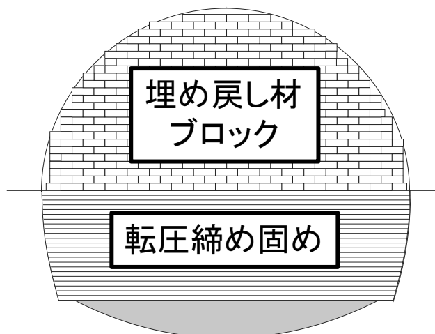
図 38 坑道の埋め戻しの概念図
