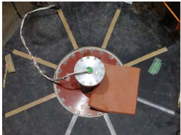
写真 7 模擬オーバーパック設置完了 内部に熱を均等に伝えるためのオイルを充填し、加熱用ヒーターを設置しました。
