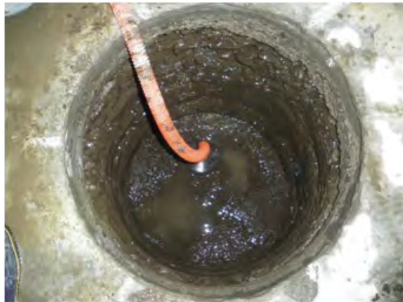
(c) 岩盤に掘削した試験孔
