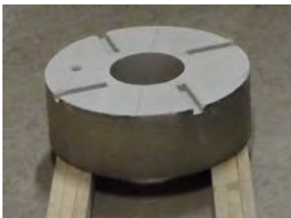
写真 16 ドーナツ型の緩衝材 直径30cm、厚さ10cmで、計測センサー設置用の溝が掘ってあります。
