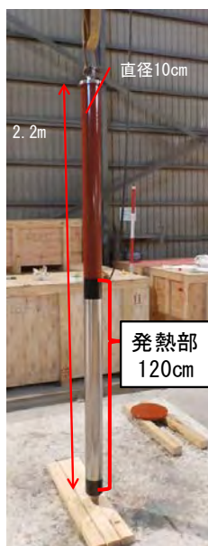
写真 15 オーバーパック腐食試験用模擬オーバーパック
