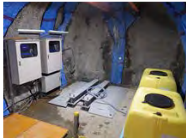
(b) 試験体設置完了状況
