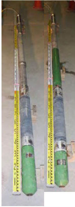
写真 37 孔内部装置 (左：注入孔用、右：揚水孔用)
