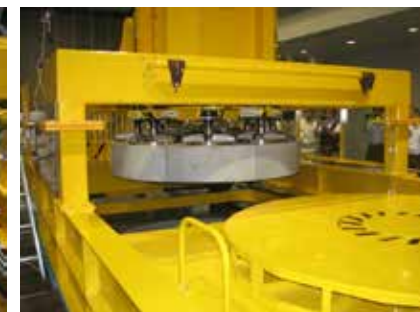
真空把持装置で緩衝材ブロックを把持し、緩衝材台車を戻す
