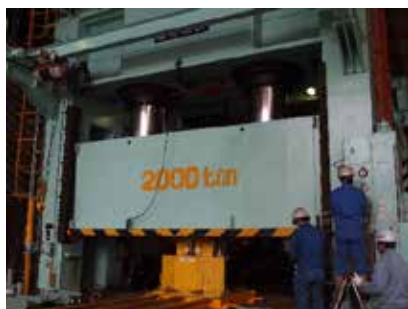
緩衝材ブロックの圧縮成形
