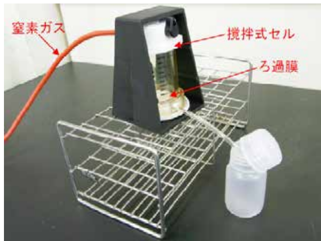
攪拌式セルを用いた加圧ろ過システム
