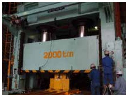
緩衝材ブロックの圧縮成形
