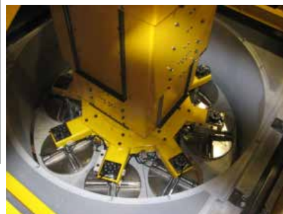
模擬処分孔へ緩衝材ブロックを降下、定置
