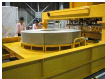
緩衝材台車をテレスコピック下部へ移動
