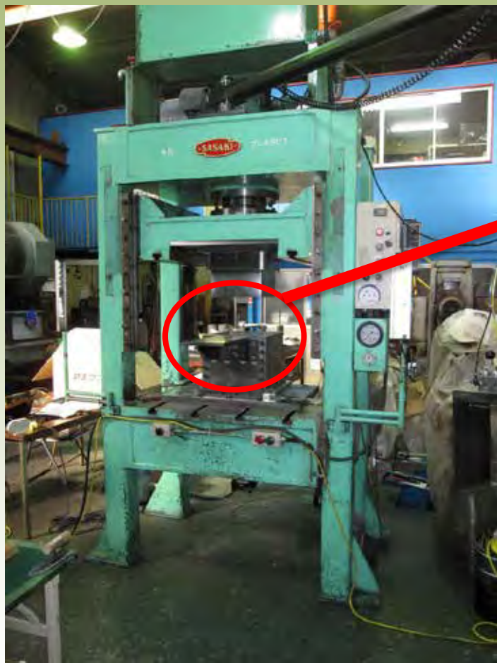
埋め戻し材ブロックを圧縮成型 するためのプレス機(80トンプレ ス)
