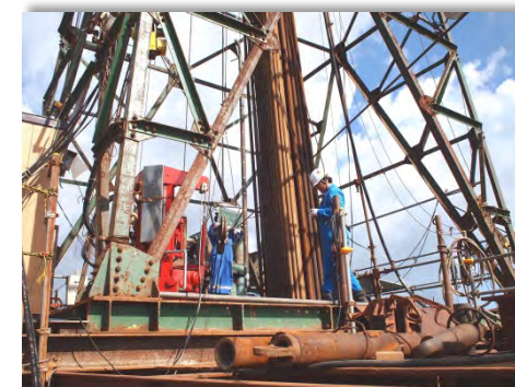
産業技術総合研究所-原子力機構 共同研究 既設ボーリング孔を用いた水理試験作業の様子 （平成24年9月、於浜里地区）
