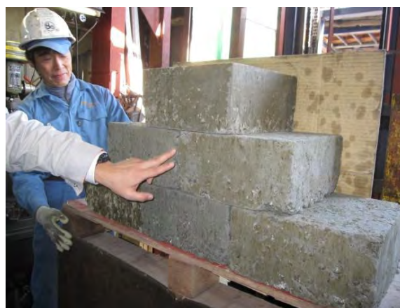
(b) 作製した埋め戻し材ブロック
