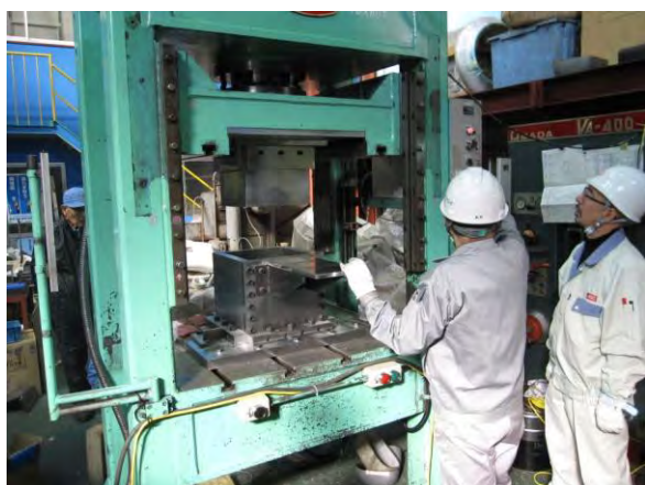
(a) 圧縮成型 (80トンプレス機)
