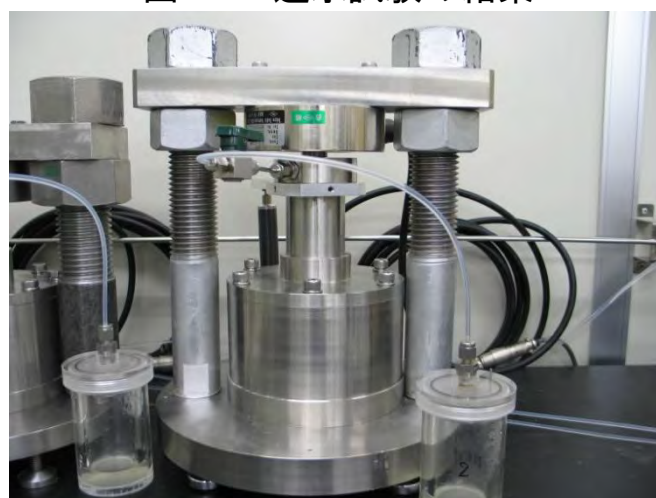
写真 3 膨潤圧試験装置の外観
